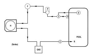
HEAT PUMP WITH GAS HEATER BACK UP
